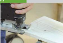
под углом 5°. Данной кромкой элементы крепятся к башне. В лотке сверлом Форстнера (D = 35 мм) высверливается углубление 5 мм. При этом доска с отверстием 35 мм используется в качестве направляющей сверла. Теперь отметьте контуры обоих элементов и вырежьте их лобзиком. Оба элемента прикручиваются изнутри к башне.
