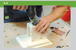
За трубой на держателе крепится дополнительная опора (поз. 9). Перед отверстием кормушки устанавливается также полукруглый элемент, который будет выполнять функцию лотка и площадки для птиц. Над отверстием для корма крепится козырёк для защиты от дождя. Отпилите кусок фанеры, из которого будут вырезаться поз. 5 + 6, по одной кромке рез производится
