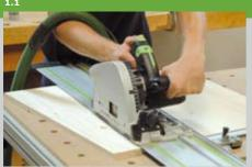
1. При помощи дисковой пилы с шиной-направляющей или монтажной дисковой пилы распилите листы фанеры по размерам, указанным в перечне заготовок. При распиловке на многофункциональном столе, показанном на рисунке, упорную планку можно поставить наклонно
