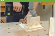
4. Отметьте на большом элементе пола две диагонали и разместите элемент пола меньшего размера таким образом, чтобы его углы находились точно на диагоналях. Соедините оба элемента пола шурупами. Теперь вы можете поставить на них башню и проверить точность посадки отверстия кормушки. При необходимости обработайте отверстие рашпилем или лобзиком.
