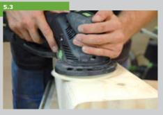
Зашлифуйте все детали башни ручным шлифовальным бруском или эксцентриковой шлифмашинкой.
