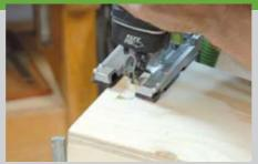
Отметьте на башне положение отверстия кормушки. Просверлите в нижних углах по отверстию диаметром 8 мм и вырежьте лобзиком дугу, используя пилку для криволинейных резов. Соедините между собой шурупами отдельные элементы держателя для трубы.
