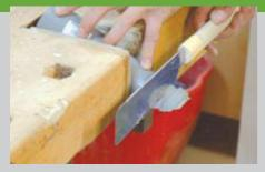
3. Вставьте трубу в башню и отметьте на нижнем конце (поз. 17) угол скоса, под которым необходимо обрезать трубу. Обрезать трубу можно ножовкой или угловой шлифмашинкой. Зачистка производится затем стационарной ленточной шлифмашинкой или напильником.
