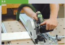
Большой элемент пола вырезается заподлицо с наружными краями башни. Все кромки элементов пола должны иметь скос 5°.
