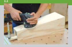
После высыхания клея боковые поверхности башни шлифуются заподлицо грубой абразивной бумагой (зернистость Р 80). Вырежьте элементы пола (поз. 3 + 4) башни. Элемент пола меньшего размера вырезается таким образом, чтобы он точно входил между стенками.
