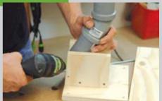
Для этого с каждой стороны (поз. 7) просверливаются отверстия 3,5 мм. Затем отдельные элементы (поз. 7 + 8) соединяются между собой шурупами Spax 3,5 x 35. Прикрутите держатель к элементу пола меньшего размера. Труба прикручивается сбоку к держателю двумя шурупами Spax 3,5 x 16.
