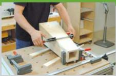
2. Склейте между собой четыре стенки. Для склеивания используется либо водостойкий столярный клей, либо полиуретановый клей. Дополнительно клеевые швы можно зафиксировать шурупами Spax 3,5 x 35 или гвоздями. Стенки надстройки башни (поз. 12 + 13) склеиваются таким же способом.
