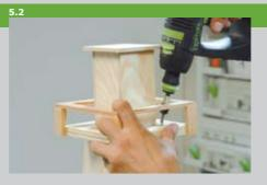
Готовая надстройка крепится к башне винтом, который служит центром вращения. Для заполнения находящейся внутри трубы кормом вся надстройка просто отвинчивается. Внешние углы башни можно скруглить вертикальным фрезером или рубанком.
