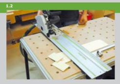
под углом 5°, что позволит легко и точно отпилить стенки кормушки. При распиловке листов толщиной 6 мм на столе необходимо использовать подкладку, так как минимальная толщина при пилении с упорной планкой составляет 15 мм.
