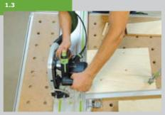
При отпиливании верхнего и нижнего края стенок (поз. 1+2) пильный диск наклоняется под углом  $5^{\circ}$ . Удобно использовать второй элемент стенки в качестве упора.
